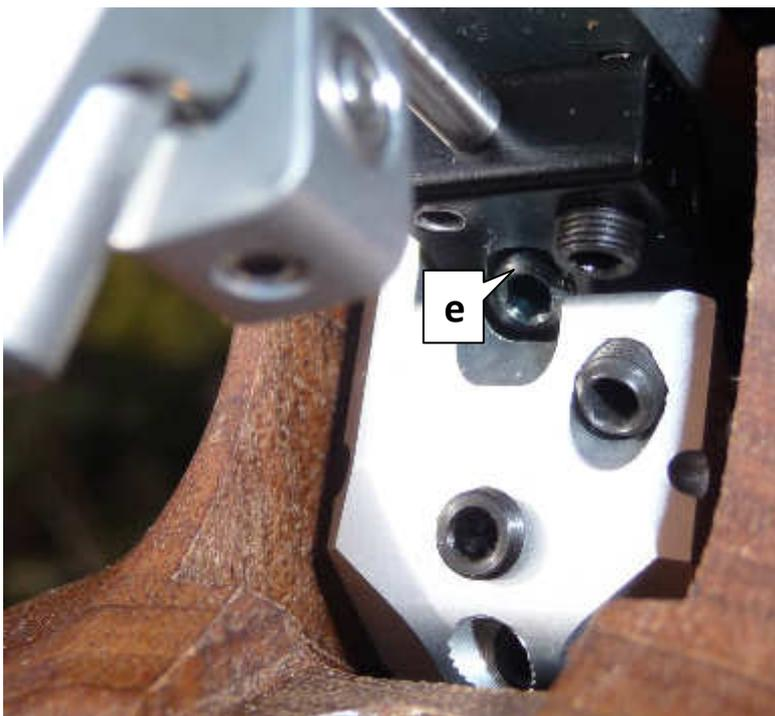
Mit dem Gewindestift (e) kann die Druckpunktposition eingestellt werden.
