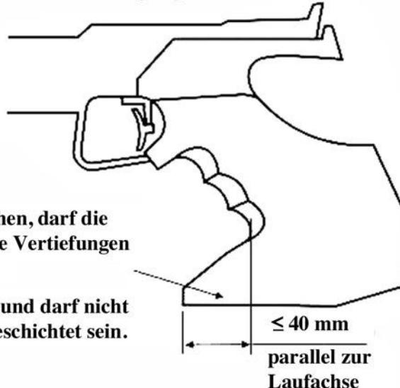
Länge der Auflage, gemessen parallel zur Laufachse, von der Vorderkante bis zur Fingerrille (kleiner Finger) 40 mm
