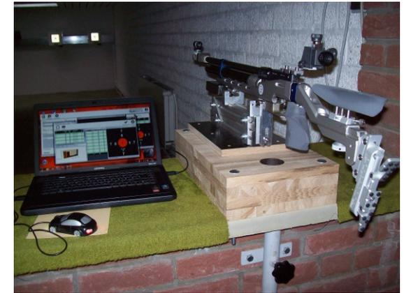
Testschießstand mit frei gelagertem Luftgewehr. Bei dieser Durchführung erfolgt bei der Schussabgabe ein natürlicher Sprung der Waffe.
