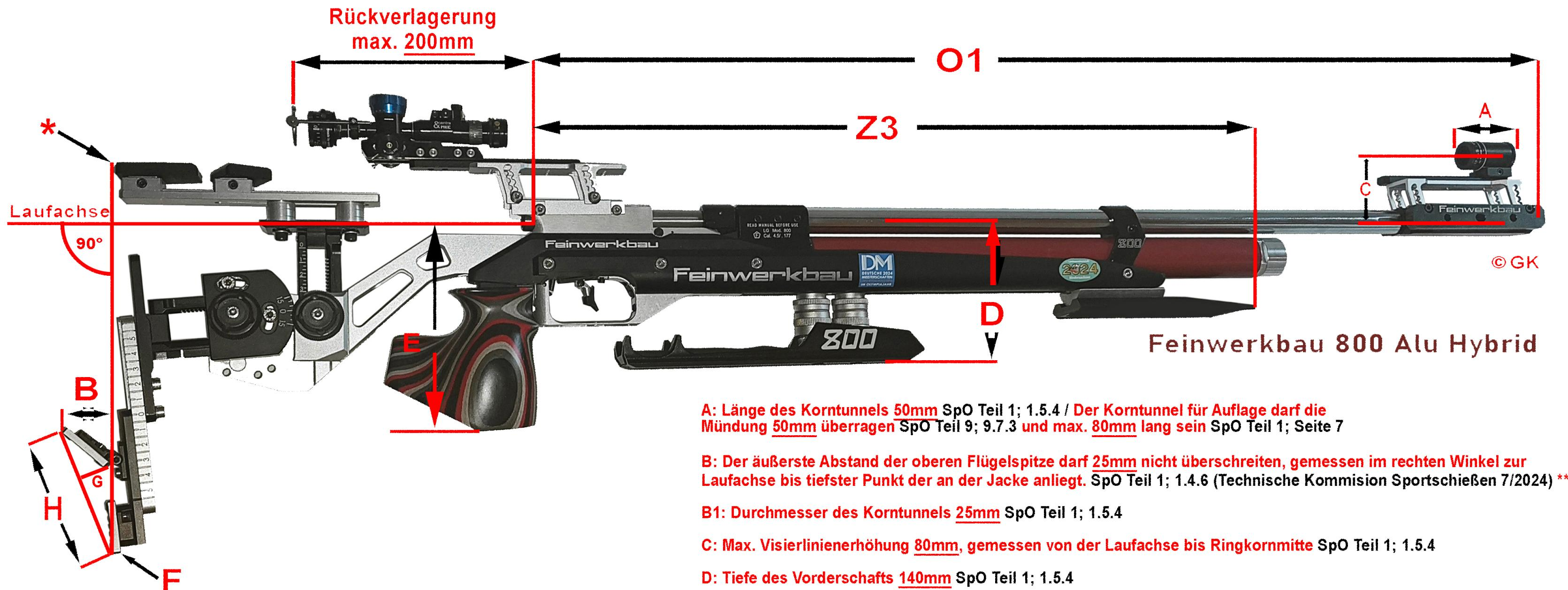
A: Länge des Korntunnels 50mm SpO Teil 1; 1.5.4 / Der Korntunnel für Auflage darf die Mündung 50mm überragen SpO Teil 9; 9.7.3 und max. 80mm lang sein SpO Teil 1; Seite 7
