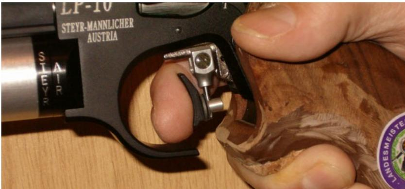
Die richtige Lage des Endglieds des Abzugsfingers wird durch das Verschieben des Abzugszüngels eingestellt.
