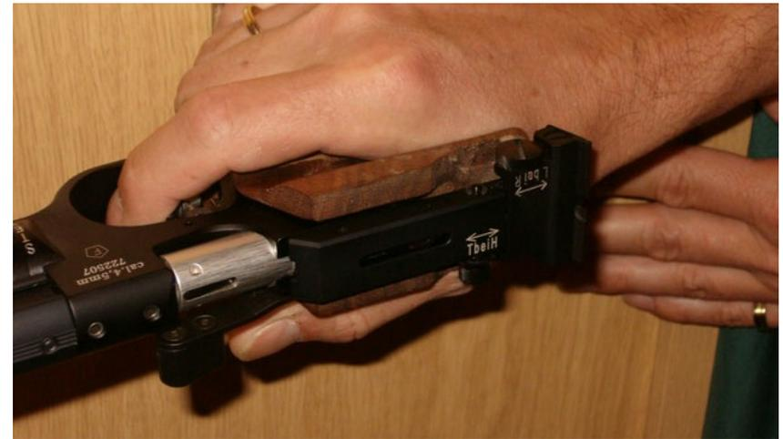
Sollte der Abzugsfinger mit dem Grund- oder Mittelglied am Griff anliegen, muss an dieser Stelle Material entfernt werden.
