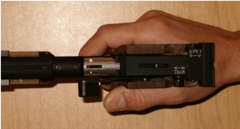
Der Daumen liegt entspannt an der Außenseite des Griffs, die Auflagefläche ist für den Daumen angepasst.
