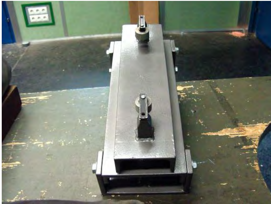
Abb. 4.7: Der „Beckbock Senior“ montiert auf einem Schießtisch im Expansionsraum. Die Dämpfungselemente (Gummiblöcke) sind in der Abbildung nicht sichtbar.
