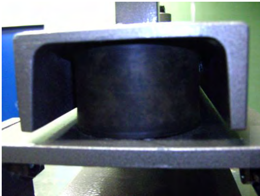
Abb. 4.8: Ein Gummiblock – Dämpfungselement des „Beckbock Senior“
