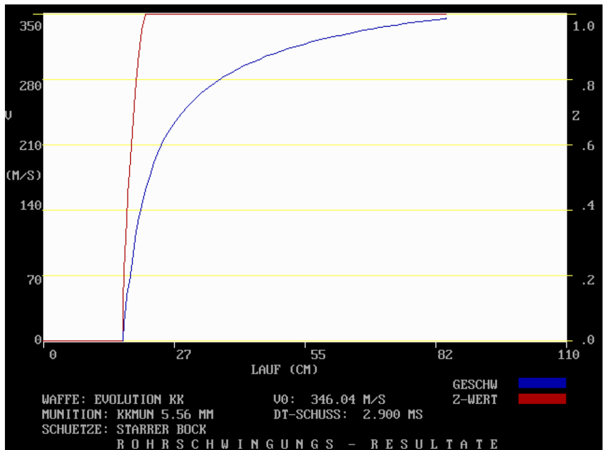
Abb. 5.28: Geschößgeschwindigkeit (blau) und Z-Wert (rot) in Abhängigkeit von der Geschößposition im Lauf.
