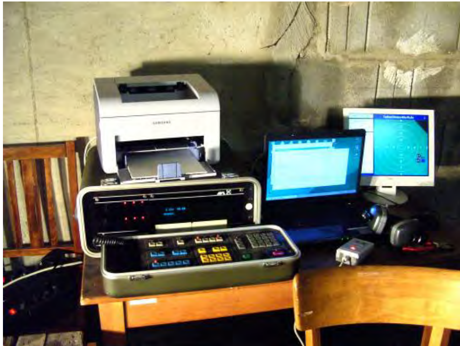
Abb. 4.4: Die Auswerteeinrichtungen. Die MEYTON Anlage, bestehend aus einem Signalprozessor (hier nicht sichtbar) mit angeschlossenem PC (Mitte), dem Bildschirm für den Schützen (rechter Bildschirm) sowie dem speziellen Bedienpult für den Schützen (kleines Kästchen bei der Sessellehne links neben dem Gehörschutzbügel). Links im Vordergrund ist die Elektronik (mit herunter geklapptem Tastaturfeld) der Geschwindigkeitsmessanlage der Firma AVL zu sehen.
