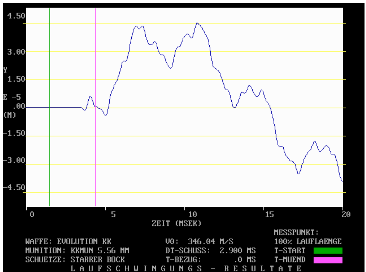
Abb. 5.8: Mit ROSSI gerechneter Zeitverlauf der Mündungsposition für das Versuchsgewehr EVOLUTION in der vertikalen Ebene bis 20 ms nach Schussbeginn. Der Schussbeginn ist der Zeitpunkt des Aufschlages des Schlagbolzens auf die Patrone. Die vertikale grüne Linie markiert den Bewegungsbeginn des Geschoßes im Lauf. Die Zeit von 0 bis zur grünen Linie entspricht in ROSSI der Zeit, in der das Pulver in der Patrone bereits zu brennen beginnt, der Gasdruck aber noch nicht ausreicht, den Auszieh Widerstand des Geschoßes aus der Patronenhülse zu überwinden. Die magentafarbene Linie markiert den Zeitpunkt des Geschoßdurchganges durch die Mündung.
