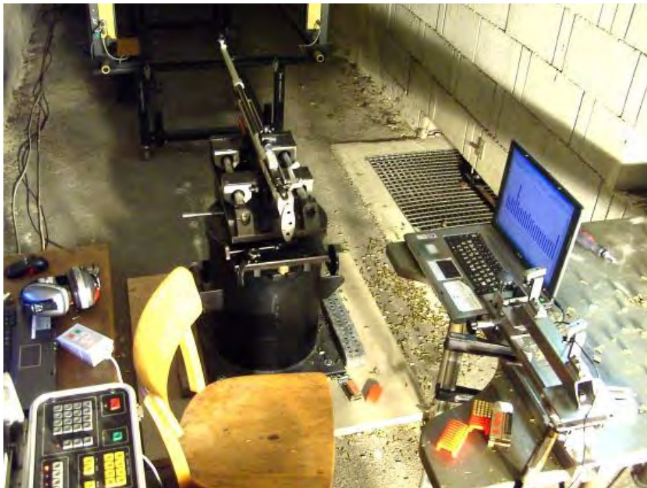
Abb. 4.5: Das Versuchsgewehr EVOLUTION eingespannt in den „Standardbock“ des HLSZ. Erkennbar ist auch die Holzplatte auf der der Bock steht.
