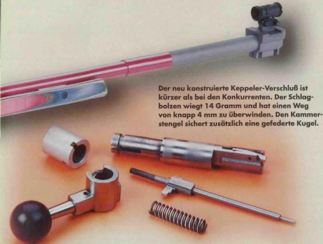
**Der neu konstruierte Keppeler-Verschluss ist kürzer als bei den Konkurrenten. Der Schlagbolzen wiegt 14 Gramm und hat einen Weg von knapp 4 mm zu überwinden. Den Kammerstengel sichert zusätzlich eine gefederte Kugel.**
