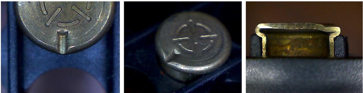
Der Schlagbolzen schlägt so richtig rein. Der Hülsenrand wird stark deformiert. Der Nachteil ist das hier wirklich viel Energie reingesteckt wird.
