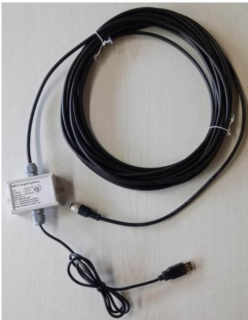
Der Schnittstelle wird von uns fertig montiert geliefert, der M12 Industriesteckverbinder dient zur Verbindung zum Messrahmen. Der USB Abgang ist mit dem Rechner bzw. Tablett zu verbinden. Der Klinkenanschluss des Netzteiltes dient zur Spannungsversorgung (24VDC/2A).
