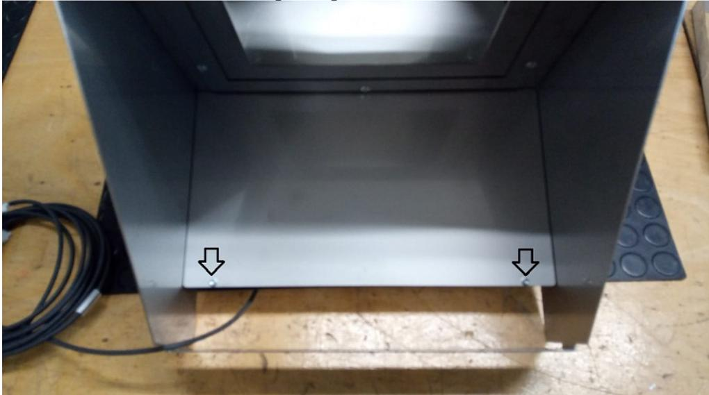
Entnehmen Sie das Abdeckblech, hier wird die Elektronik sichtbar.
