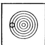
Bei Hochschuß Höhenverstellschraube rechts herumdrehen.
